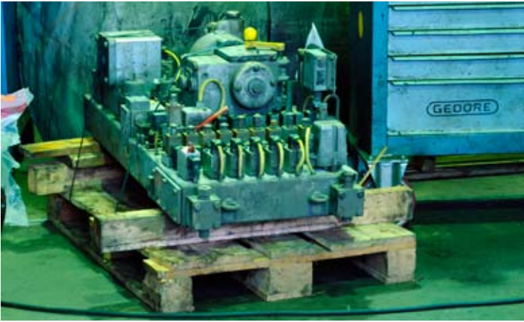
Links: revisie en keuring van de remtafel mag door slechts enkele erkende bedrijven plaatsvinden. De module wordt daartoe gedemonteerd en naar Duitsland overgebracht. Rechts: GKN Services demonteert en controleert de aandrijfassen (cardanassen). Na vervanging van de aan slijtage onderhevige delen worden de componenten, vergezeld van de benodigde certificeringsbescheiden, teruggesteerd en weer ingebouwd.
