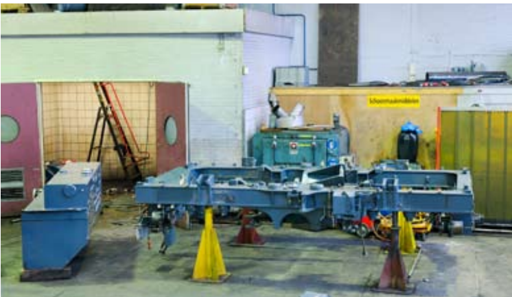
Links: de draaistelframes worden ontdaan van alle losse componenten: de wiel- en aandrijfassen, maar ook de remcilinders, schokbrekers en veerinrichting. De reinrichting, aandrijfassen en dieseltanks gaan voor revisie, reiniging en keuring naar daartoe gecertificeerde instanties. Daarna worden alle componenten weer gemonteerd en van een nieuwe laklaag voorzien. De draaistellen en wielassen ondergaan een NDO (niet-destructief onderzoek). Rechts: een opname van de wielassen en zandbakken. De olie van de aandrijfbakken wordt bemonsterd en opgestuurd voor analyse. De aandrijfbakken krijgen middels endoscopie een inwendige controle op overmatige slijtage en gebreken. De wielassen worden met ultrasoon geluid onderzocht en volgens een vastgesteld protocol opnieuw ingemeten.
