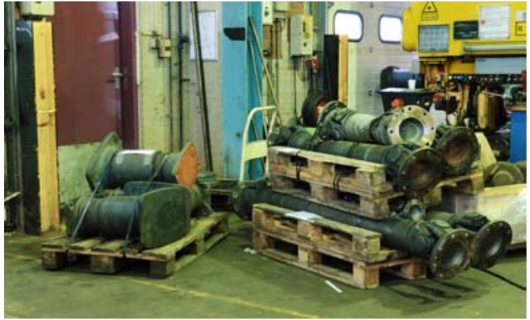
Links: revisie en keuring van de remtafel mag door slechts enkele erkende bedrijven plaatsvinden. De module wordt daartoe gedemonteerd en naar Duitsland overgebracht. Rechts: GKN Services demonteert en controleert de aandrijfassen (cardanassen). Na vervanging van de aan slijtage onderhevige delen worden de componenten, vergezeld van de benodigde certificeringsbescheiden, teruggesteerd en weer ingebouwd.
