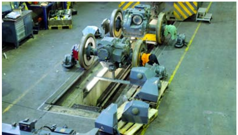
Links: de draaistelframes worden ontdaan van alle losse componenten: de wiel- en aandrijfassen, maar ook de remcilinders, schokbrekers en veerinrichting. De reinrichting, aandrijfassen en dieseltanks gaan voor revisie, reiniging en keuring naar daartoe gecertificeerde instanties. Daarna worden alle componenten weer gemonteerd en van een nieuwe laklaag voorzien. De draaistellen en wielassen ondergaan een NDO (niet-destructief onderzoek). Rechts: een opname van de wielassen en zandbakken. De olie van de aandrijfbakken wordt bemonsterd en opgestuurd voor analyse. De aandrijfbakken krijgen middels endoscopie een inwendige controle op overmatige slijtage en gebreken. De wielassen worden met ultrasoon geluid onderzocht en volgens een vastgesteld protocol opnieuw ingemeten.
